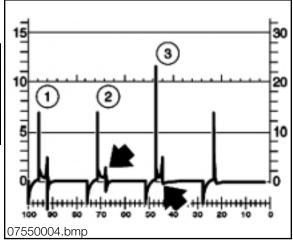
No Sparking Volatge Line (Single Cylinder Displayed)
