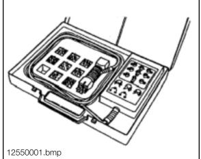
SKE BREAKOUT BOX SET P/N 90 88 6 121 300 BOX 26 PIN BOX 88 88 6 611 459 13550063.eps
